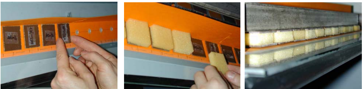
Fig. 4. Incollaggio della bachelite sulla faccia superiore del distanziatore. La pressione sui campioni viene esercitata da una barra di acciaio.
