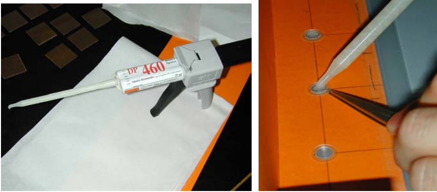
Fig. 3 A sinistra, miscelatore e distributore della 3M per la colla in uso; a destra, deposizione della colla sugli spaziatori
