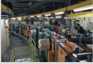
Fig. 2.4 – Photo du Booster du Synchrotron à protons.
