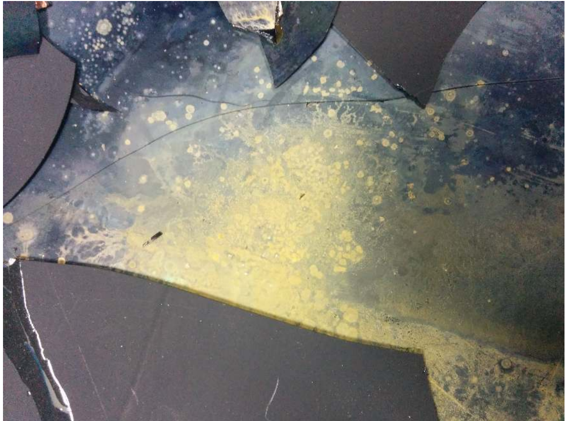
Fig. 5.59 – Vue intérieure d'une chambre du télescope du GIF++. Les spacers ont disparu et un dépôt s'est formé sur les électrodes.
