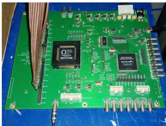
Fig. 5.66 – La carte de test pour le banc cosmique.
