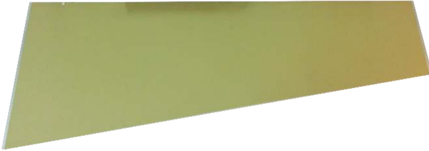
Fig. 7.4 – Le prototype de PCB avec lecture des strips des deux côtés.
