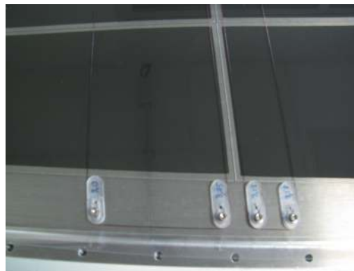
(b) Les plots assurant le maintien des verres ainsi que les fils de pêche assurant l'espace entre les électrodes d'un gap .
