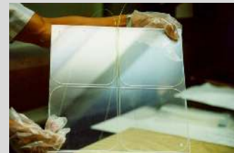
Fig. 3.17 – Photo d'une tuile du HO avec des fibres WLS insérées dans les 4 \sigma -rainures.
