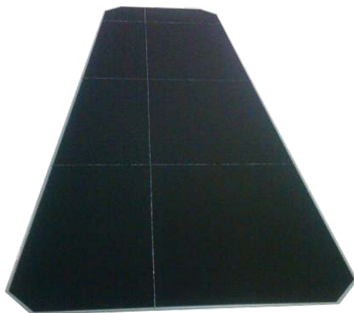
(a) Gap (i) hermétique formé par collage des verres. On distingue clairement les zones de collage.
