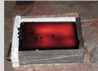
Fig. 5.3 – Refroidissement d'un bloc de verre de basse résistivité.
