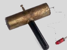
Fig. 4.1 – Photo d'un des premiers tubes GEIGER-MÜLLER fabriqué en 1932 par HANS GEIGER pour une utilisation en laboratoire.
