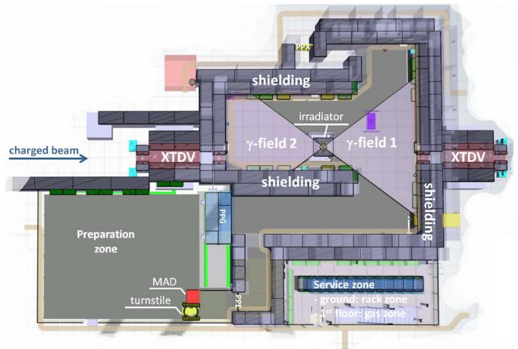
(a) Schéma de l'intérieur du Bunker du GIF++.
