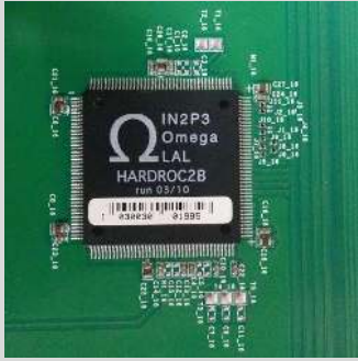
Fig. 5.7 – Vue d'un HARDROC soudé.
