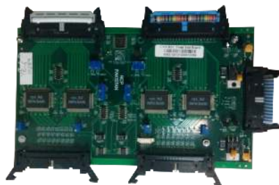
Fig. 4.28 – Une Front-End Board des chambres RPC dans les bouchons de CMS. Les 4 ASIC sont clairement visibles sur le PCB. Les strips sont reliés aux connecteurs du bas et les signaux Low-Voltage Differential Signaling (LVDS) sont envoyés grâce aux câbles reliés aux connecteurs du haut. Le connecteur sur la droite est, quant à lui, relié au Distribution Board (DB) et amène la basse tension et les signaux I 2 C.
