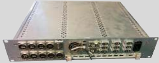
Fig. 5.44 – Boîte contrôlable à distance contenant la SDCC etc.
