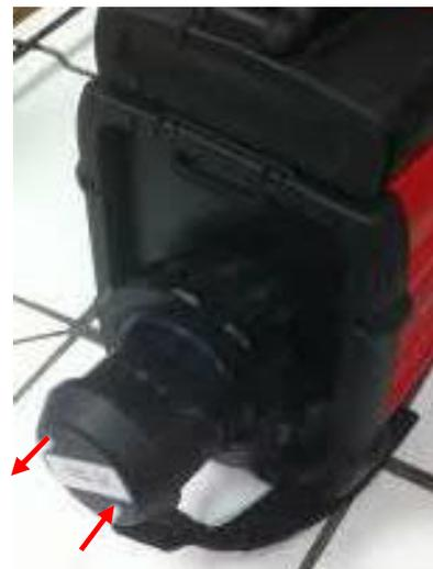
La cellule de mesure par angle rasant a été modifiée pour en faire une cellule de mesure en phase gazeuse. Deux trous ont été percés et des tubes d'alimentation ont été fixés afin de faire circuler le mélange gazeux à l'intérieur.
