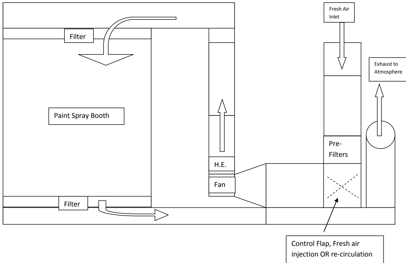
Giclage injection d'air frais/ Spraying Fresh air injection
